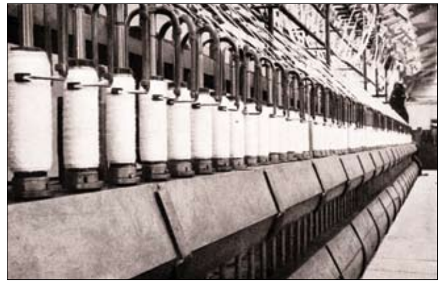
Fig. 7: Tessitoio ad aletta nel reparto del vetro tessile, Vetreria Balzaretti Modigliani, Livorno (da L'industria del vetro in Italia 1940).
