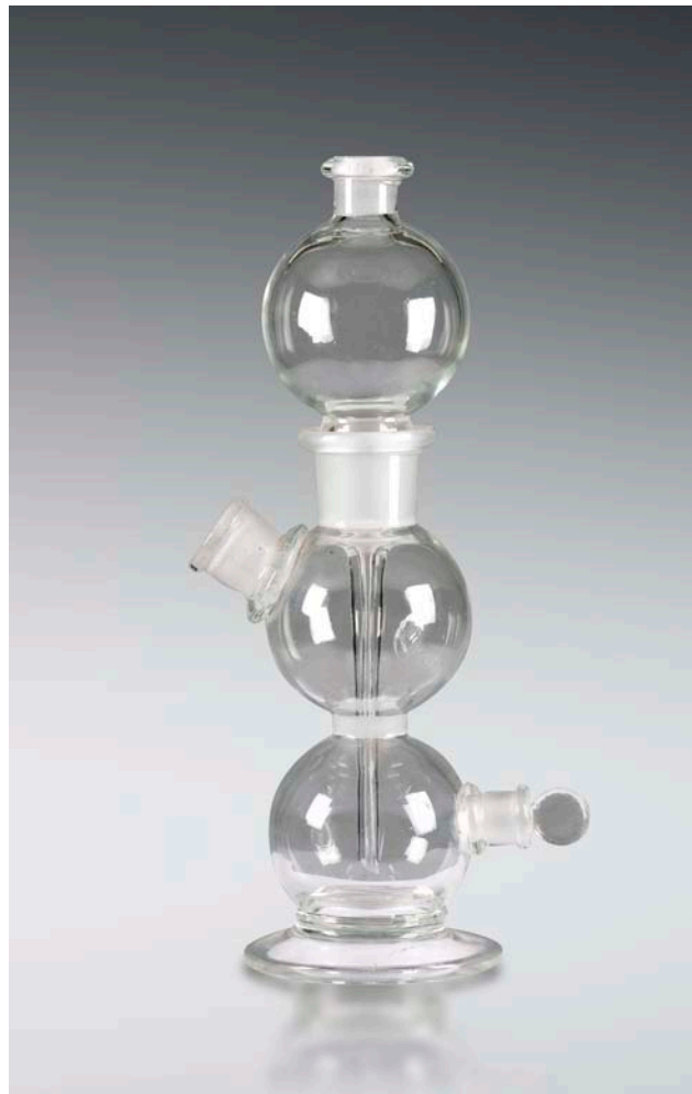
Fig. 6. Apparecchio di Kipp a base sferica, prima metà XX secolo. S.A.V. Vetro bianco soffiato.
