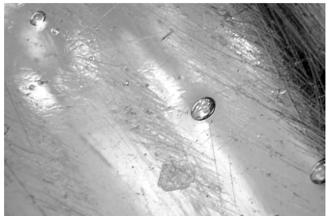
Fig. 8. Particolare delle abrasioni al microscopio digitale.
